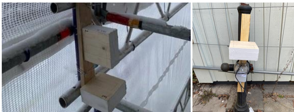
Figur 7. Uppställning mikrobiell provtagning inuti och utanför väderskyddet (exempel)
